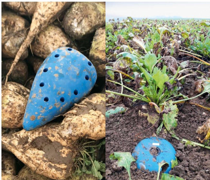
La betterave connectée a le même aspect qu'une vraie betterave. La seule différence est qu'elle est remplie de capteurs de mouvements 3D.
